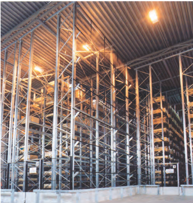
Safestore kombiniert mit FlexiGuard als Einzäunung eines automatischen Lagers.
